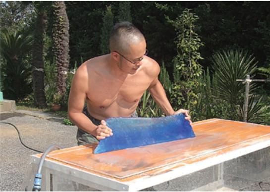
型から取り出した鑄造ガラスを、板ガラスと擦りながら砂で削り、平らにします。ガラスを磨き、オトコを磨きます！
